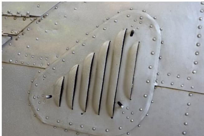
► Figura 28 - Corrosione superficiale sulla fusoliera in alluminio del Dewoitine D.530.
