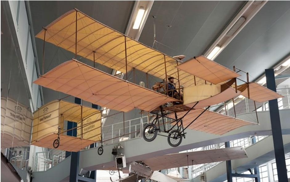
Figura 7 - La copia del Voisin 1Bis di Farman, realizzata dal Costruttore Voisin dopo la Grande Guerra. Da allora, prima di essere esposta, è stata oggetto di diversi interventi di ripristino e sostituzione di alcuni materiali, in particolare dell'intelleggio. *La copie du Voisin 1Bis de Farman, réalisée par le Constructeur Voisin après la Grande Guerre. Elle a fait l'objet depuis de plusieurs remises en état d'exposition par substitution de certains matériaux, l'entoilage notamment.*
