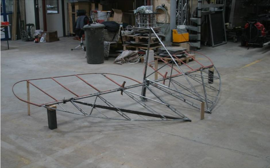
I piani di coda del Rumpler C.IV al termine delle operazioni di restauro ed integrazione degli elementi mancanti.
