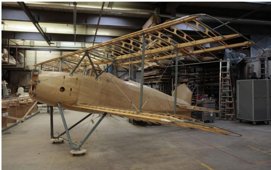
Un Albatros D.III durante il primo assemblaggio di prova.
