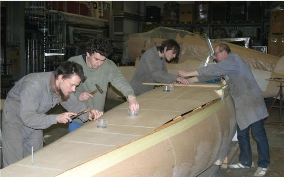
Schnell! Il rivestimento in compensato viene incollato ed inchiodato alla fusoliera di un Albatross D.III.
