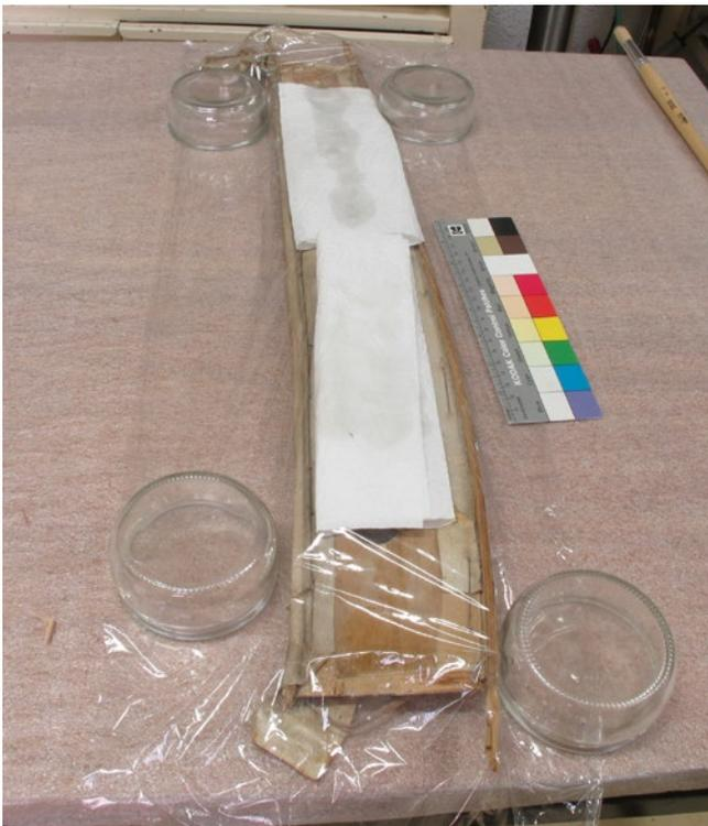
◀ Figura 21 - Il ripristino planare del compensato nell'anima di una centina d'aereo del 1918.
