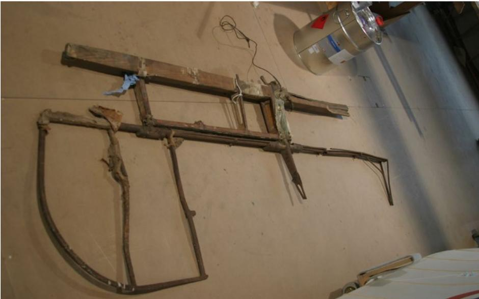
Ciò che resta dell'unico alettone sopravvissuto del Rumpler C.IV, prima di essere disassemblato ed analizzato.
