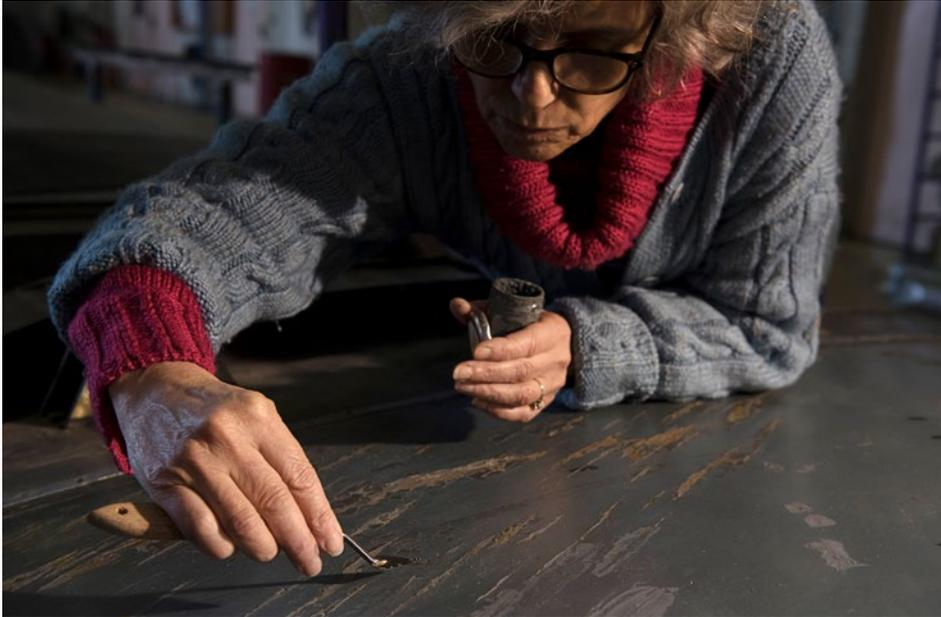
Figura 22 - Stuccatura delle lacerazioni dello strato pittorico e incollaggio dell'ala dell'aereo Yakovlev Yak 3 del museo.
